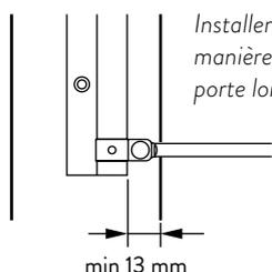
Installer le bras déporté (minimum 13 mm) de manière à ne pas interrompre l'ouverture de la porte lorsqu'elle est en position OFF.
