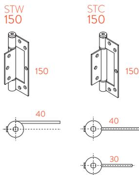
STW: Eje desplazado de la pala que permite su instalación sin necesidad de premarco
