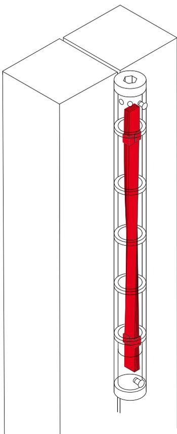
Nuestra **empaquetadura** o **fleje** es un sistema compuesto por un conjunto de láminas que trabajan por torsión y que son la base del alto rendimiento de la acción de muelle de nuestras bisagras.
