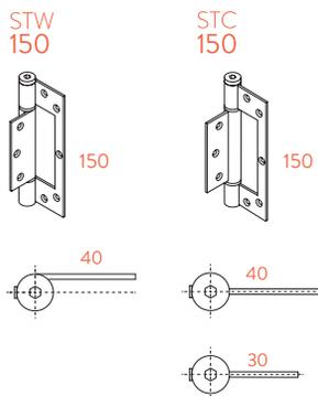
STW: Eje desplazado de la pala que permite su instalación sin necesidad de premarco o directamente sobre la pared
